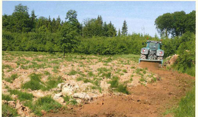
Der Forstmulcher zerkleinert Äste und Grasfilz. In dem feinkrümeligen Boden läuft das Saatgut hervorragend auf.
